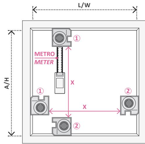
Posizionare due distanziatori (1 e 2) ai lati opposti della finestra e misurare con un metro la misura **X**. Ripetere l'operazione in tre diversi punti, sia per l'altezza (A) che per la larghezza (L). Prendere in considerazione l'altezza e la larghezza più piccole misurate (**X**) e aggiungere ad entrambe 100 mm (**Y**).
